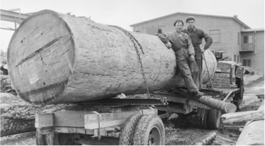
Jättelika mahognystockar sågades upp till båtbyggare och snickerier på sågverket i Sala. Den största stock man hanterat var 12 meter lång och hade en diameter på nästan 2 meter.
